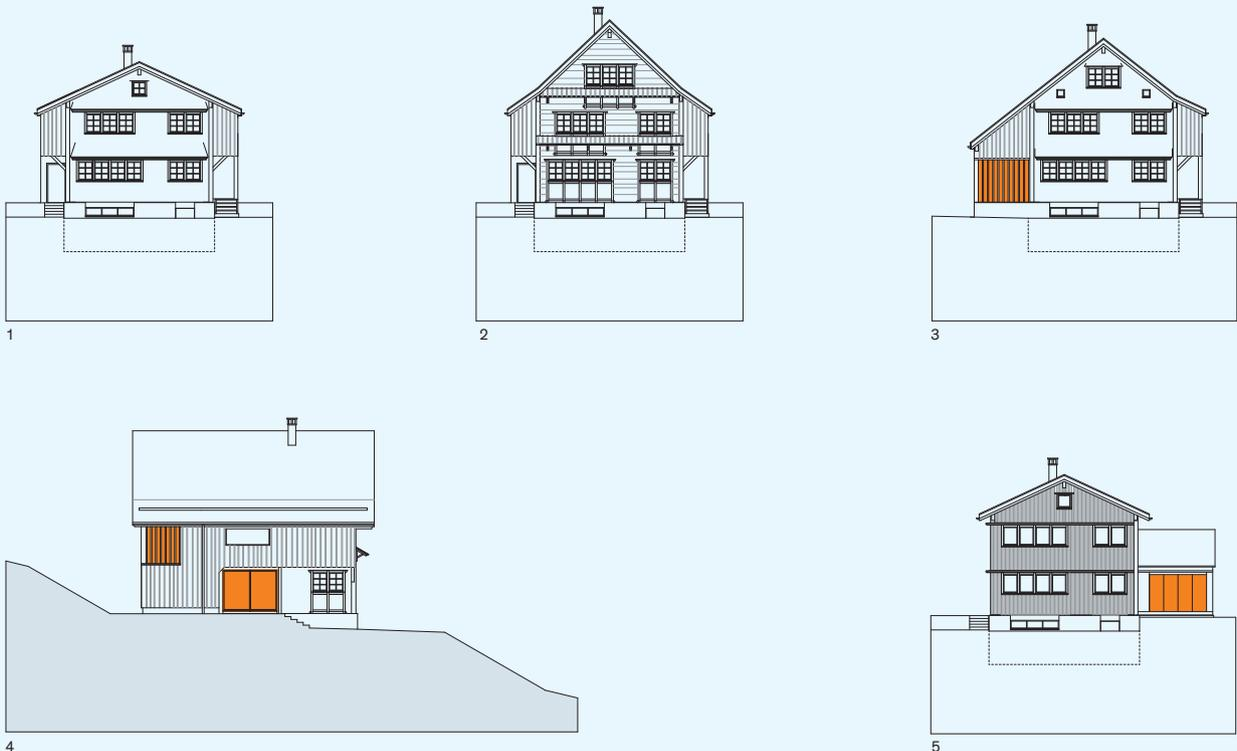
Beispiele für die Fassadengliederung mit Kleb- und Abwurfdächli sowie mit gezielt eingesetzten Spezialfenstern:
