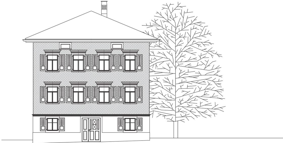
Planskizze eines typischen, aus der Stickereizeit stammenden Wohnhauses, dessen Holzurundschindeln und Ecklisenen im Laufe der Zeit entfernt und durch Faserzementschindeln ersetzt wurden.
